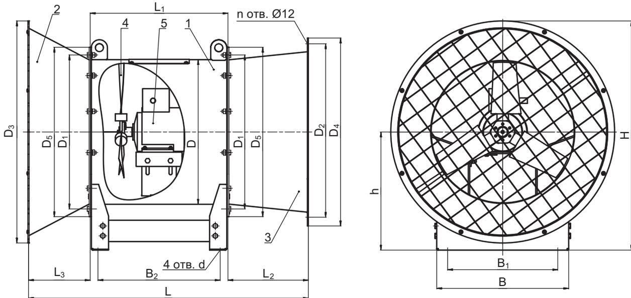
1 – вентилятор; 2 – конфузор; 3 – диффузор; 4 – рабочее колесо; 5 – электродвигатель.
